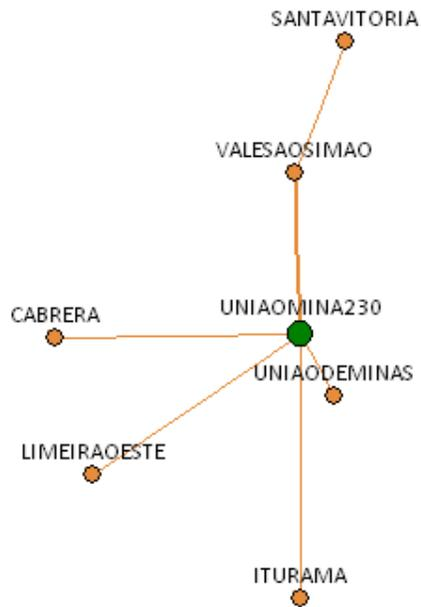
**Figura 5-22 – União de Minas: diagrama unifilar da rede projetada**
