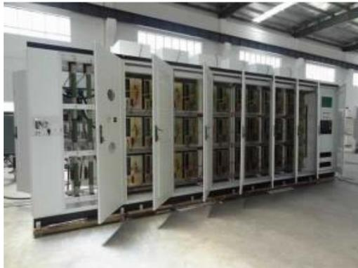
Figura 10 – Compensador Estático Síncrono[21].
