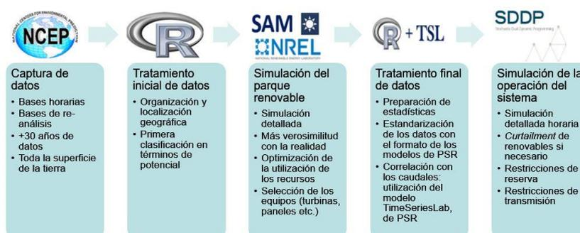
Figura 1: Proceso para obtener las series de producción de las renovables.
