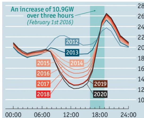
Como pode ser visto, a penetração de fontes renováveis intermitentes causa impactos representativos no perfil de demanda líquida. Destacam-se as maiores inclinações nas rampas de demanda líquida com maior penetração de fontes de geração renovável. Esses impactos levam a novos desafios operativos no sistema, dentre os quais destacam-se:
