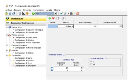
Los botones localizados encima de la lista permiten adicionar y eliminar enlaces CC e ordenar los mismos en forma ascendente y descendente. En la parte inferior de la pantalla se presenta, para el enlace CC seleccionado, la información básica que debe ser ingresada para los enlaces CC que se presentan a continuación:
