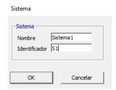
El identificador se utiliza en la creación de archivos ASCII generados por la interfaz. Por ejemplo, el nombre del archivo de configuración térmica es ctermis1.dat, donde s1 es el identificador del sistema.
