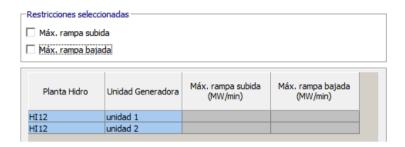
En esta pantalla se ingresan los valores máximos de las rampas de subida y bajada para las unidades que tiene esta restricción.
