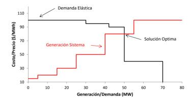
Como se observa en la figura la solución óptima es abastecer una demanda de 50 MW.
