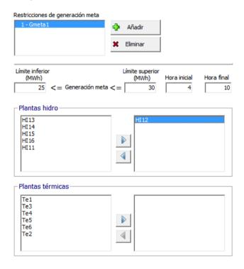
El ejemplo de la figura se interpreta de la siguiente forma: entre la hora 4 y la hora 10 de la simulación, la generación total de la planta hidroeléctrica HI12 debe ser mayor o igual que 25 MWh y menor o igual que 30 MWh.
