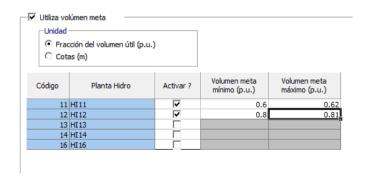
Se puede definir el nivel final del embalse por medio de una fracción del volumen útil (entre 0 y 1) o por medio de una cota, en este último caso, es necesario que la tabla Volumen x Cota esté definida para todas las plantas en las que se activará el volumen meta.
