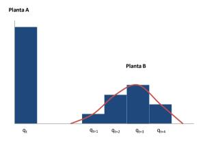
La inclusión de este tipo de restricciones hace que la simulación dependa de las condiciones operativas existentes antes del inicio del estudio. En el ejemplo presentado se debe informar las condiciones de generación de la planta hasta 4 horas antes del inicio del estudio.
