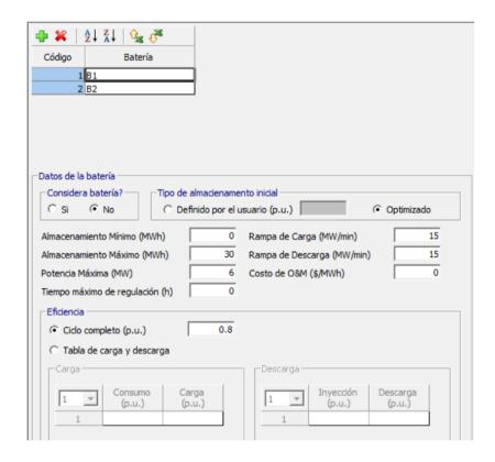
Los botones que se encuentran encima de la lista de baterías permiten añadir o eliminar una batería y ordenar las mismas en orden ascendente o descendente. Debajo de la lista de baterías, se presentan, para la batería seleccionada, los datos básicos que el usuario debe ingresar. Estos datos son los siguientes:
