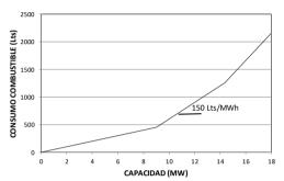
Observe que el Consumo Específico es el valor de la pendiente de los segmentos lineales. Para una carga de 50% (9 MWh), el consumo de combustible es de 9x50=450 lts/hora. Para una carga de 80% (9+5.4=14.4 MWh), el consumo de combustible es de 450+5.4\*150=1260 lts/hora. Para la carga de 100% (14.4+3.6=18 MWh), el consumo de combustible es de 1260+3.6\*250=2160 lts/hora. Observe que debido a que la unidad de tiempo es de 1 hora el valor de la energía es igual al de la potencia.
