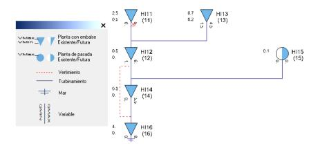
En la parte izquierda de esta figura se presentan las referencias del dibujo. Observe por ejemplo que la planta HI13 es una planta con embalse que turbina y vierte a la planta HI12, la planta HI15 es una planta de pasada futura, es decir que no será considerada en el estudio. La planta con embalse HI12 turbina a la planta HI14 y vierte a la planta HI16. La planta HI11 no vierte a ninguna planta.
