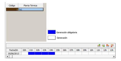
La información cronológica que se debe ingresar en la parte inferior se realiza por medio de las paletas, en las que el color azul representa las horas en las que la planta termoeléctrica debe funcionar en forma obligada, el resto del tiempo (color blanco) la decisión de operar la planta termoeléctrica depende del despacho económico.
