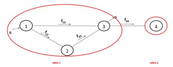
El sistema está compuesto de 4 barras y 4 líneas de transmisión. En la figura se presenta el sentido positivo del flujo en las líneas de transmisión, por ejemplo, el flujo entre las barras 2 y 3 es positivo si el mismo va desde la barra 2 hacia la barra 3.
